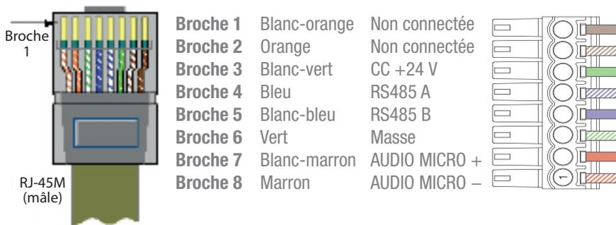
Le microphone doit être raccordé au système matriciel au moyen du câble de connexion fixe d'une longueur de 2 mètres. La distance peut être étendue jusqu'à un maximum de 300 mètres, en utilisant un câblage à paires torsadées CAT5e (ou supérieur).
