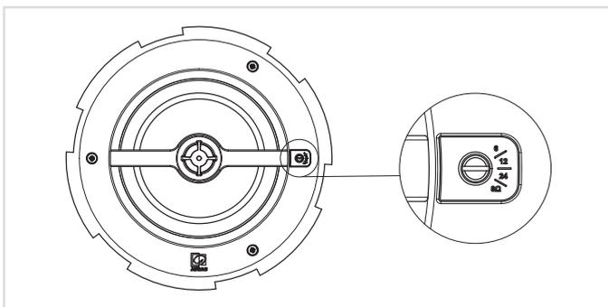
A l'aide d'un tournevis à tête plate, il est possible de choisir la puissance de sortie ou le fonctionnement en basse impédance.
