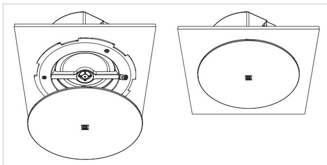
Montez la grille sur l'enceinte en insérant les excroissances dans les ouvertures prévues à cet effet dans le baffle de l'enceinte et tournez-la partiellement (de 15°).
