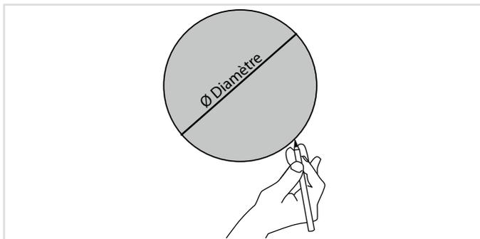
Découpez un trou à l'emplacement de montage dans le plafond. Assurez-vous que la diamètre correspond à la découpe nécessaire à l'enceinte.
