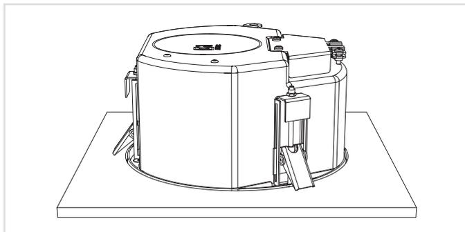
Fixez l'enceinte dans l'ouverture créée en serrant les vis des pinces de montage au moyen d'un tournevis.
