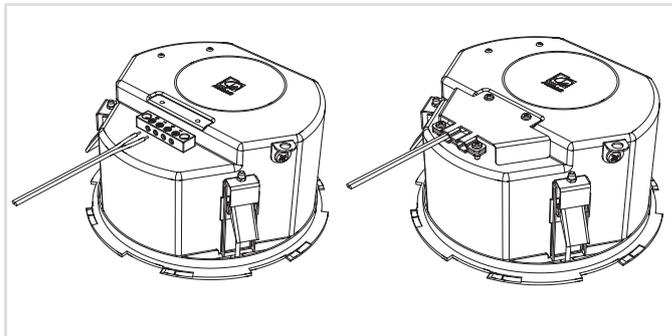
Retirez le cache et branchez le câble aux borniers de connexion en céramique en insérant les fils dans les trous correspondants et en serrant la vis. Les deux autres borniers permettent de relier d'autres enceintes.
