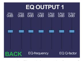
Le réglage des fréquences centrales se fait de la même manière que pour les filtres ci-dessus et les facteurs Q peuvent être changés après sélection en tournant la molette dans le sens horaire (augmentation) ou antihoraire (diminution). La valeur choisie est confirmée après nouvelle pression de la molette. Une fois la valeur requise réglée pour chaque bande, utiliser le bouton « Back » permet de revenir à l'écran de l'égaliseur.
