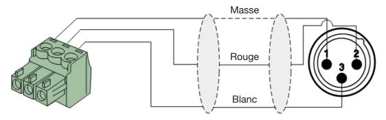
Pour les connexions symétriques de sortie ligne :
