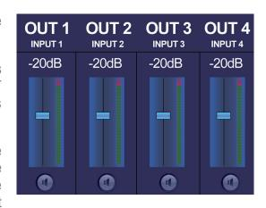
être changé en tournant la molette de fonction dans le sens horaire (augmentation) ou antihoraire (diminution). Le fader montera ou descendra lors du réglage du niveau de sortie. Le niveau de sortie peut être réglé dans une plage allant de 0 dB à -70 dB.
